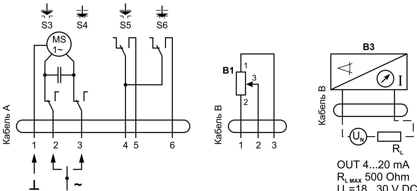
Рис. 8-6. Схема электрических соединений для электроприводов SP MIKRO.
