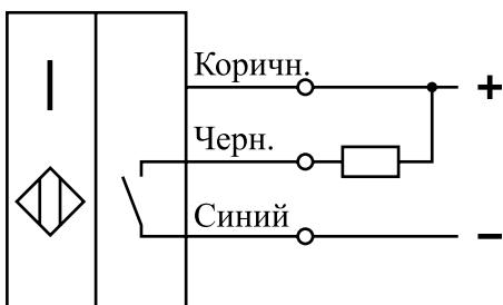
*Схема подключения индуктивной нагрузки*
